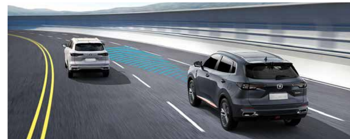
Advertencia de desviación de carril (sonido y vibración del volante).
