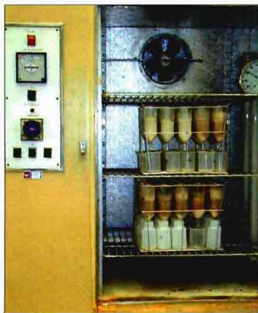
Cámara de incubación con control de temperatura y humedad.
