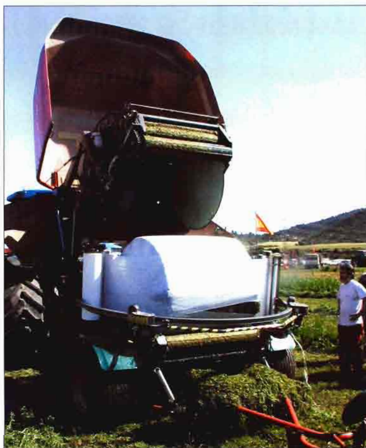
Foto 7. Encintadora con encintado en la cámara de empacado. Documentación Kverneland.
