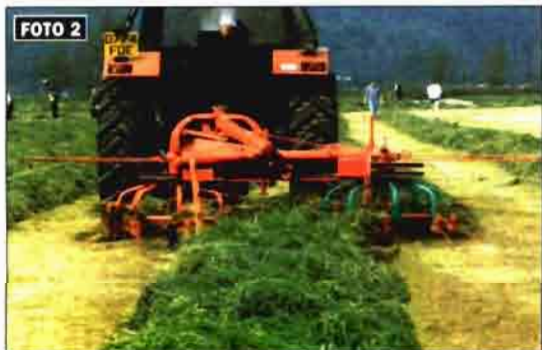
Foto 1. Rastrillo de horquillas inclinadas. Documentación John Deere. Foto 2. Rastrillo de horquillas horizontales. Documentación Kverneland. Foto 3. Rastrillo de dientes oscilantes. Documentación Kuhn.
