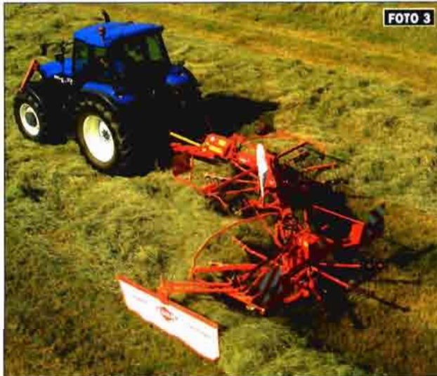
Foto 1. Rastrillo de horquillas inclinadas. Documentación John Deere. Foto 2. Rastrillo de horquillas horizontales. Documentación Kverneland. Foto 3. Rastrillo de dientes oscilantes. Documentación Kuhn.
