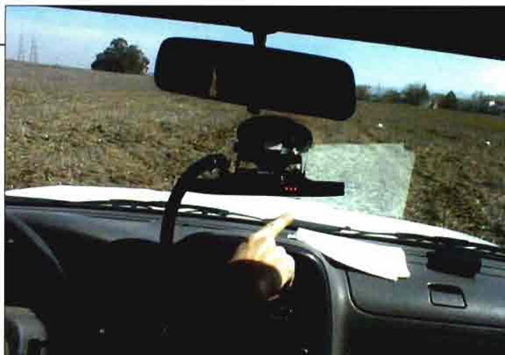
El uso de una barra de luces no puede ser más intuitivo: dejarse guiar por las indicaciones luminosas a derecha o izquierda (S&C Ibérica).
