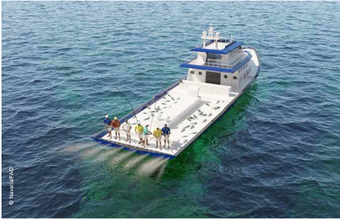
FIGURA 37 Embarcación para la pesca con cañas y líneas de 30 m (LP) (tipo maldivo - Masdhoni)
