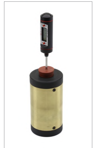
Este cilindro calorimétrico, fabricado en latón, puede montarse y desmontarse fácilmente del pivote del equipo.
