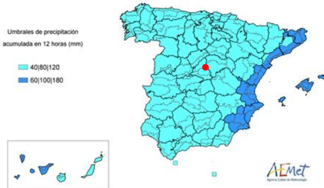
Figura 9: Zonificaci3n del territorio nacional atendiendo a los umbrales lfmite de precipitaci3n acumulada en 12 horas (mm), y niveles de aviso amarillo, naranja y rojo, segun el Plan Nacional de Predicci3n y Vigilancia de fen3menos meteorol3gicos adversos, elaborado por la AEMET.
