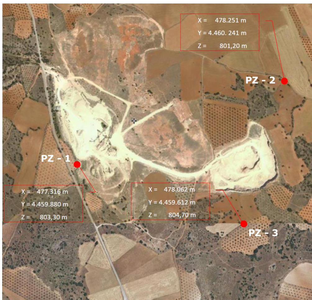
Figura 47. Localización de los sondeos de control piezométrico.
