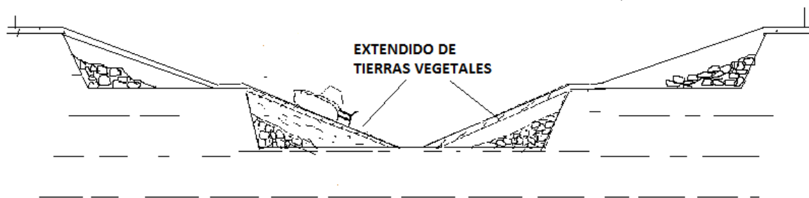
Figura 34. Perfilado de taludes
