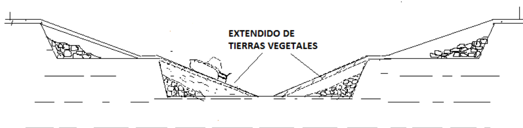
Figura 67. Perfilado de taludes de restauración
