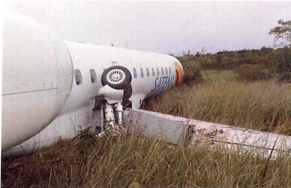
Daño en el tren principal derecho y flap
