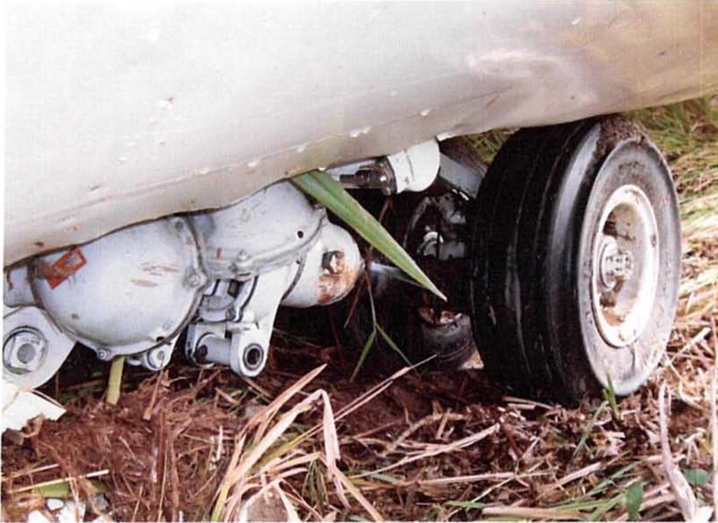
Daño en el tren de nariz
