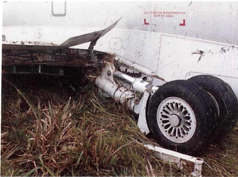
Daño en el tren principal izquierdo y flap
