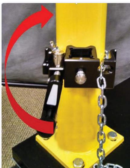
Figura 2.26 Tensando la cadena
