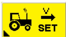
Calibrar velocidad - Menú: Aquí puede calibrarse la velocidad de marcha. Por lo demás, pueden guardarse y cargarse varios valores de calibración para distintos vehículos. Detalles en el [punto 3.3.4.](#)
