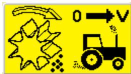
Con esta tecla puede iniciarse la predosificación. Pulsando y manteniendo pulsada la tecla, se gira el eje de siembra conforme a las rpm determinadas a través de la prueba de desprendimiento. En cuanto se suelta, se vuelve a la velocidad de marcha para regular el eje de siembra. De este modo podrán evitarse superficies no sembradas, al inicio del campo o en paradas en el campo.
