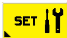
En el menú SET se realizan los ajustes de la máquina. Aquí se realiza una prueba de desprendimiento, se selecciona la semilla, se calibra la velocidad de marcha, los ajustes del terminal como idioma y unidades de medida.
