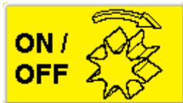
Con esta tecla puede activarse o desactivarse el eje de siembra. En caso de que lleve montado una turbina eléctrica, esta se iniciará automáticamente. Solo después comienza a girar el eje de siembra.
