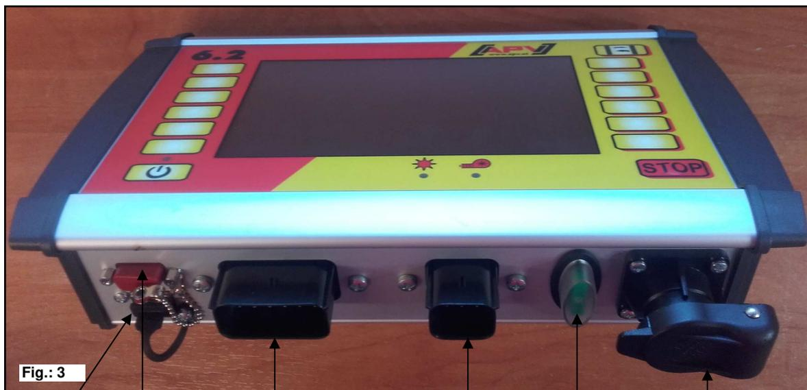
Clavija USB                      Conector de 12 polos                      Fusible de 30A                      Conector de 3 polos
