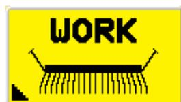
En el menú WORK se muestra íntegramente la información importante del campo para el funcionamiento. Desde aquí se pueden accionar y apagar los motores, además de mostrarse información como la velocidad de la marca, la posición de trabajo y las rpm del eje de siembra. Descripción más detallada en el [punto 3.2](#).
