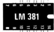
Fig. 5 Numerazione dei terminali dell'integrato LM381 visto da sopra. (Si noti la tacca di riferimento).
