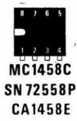
Fig. 5 Zoccolature del doppio amplificatore differenziale. Questo integrato può essere reperibile nelle seguenti sigle - MC.1458/C - SN72558/P - CA.1458/E - SFC.2458/DC.
