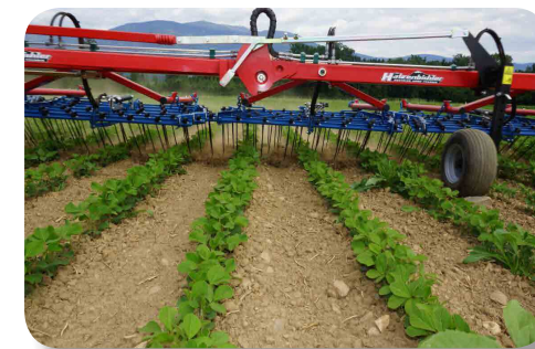
Placa niveladora con muelle, 1,5 m para nivelar toperas, montículos, etc...
