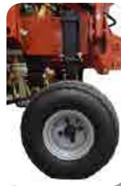
Rueda de soporte con altura variable en semieje y rodamiento de bolas
