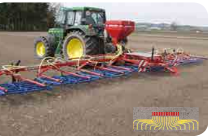
Almohaza de ancho de trabajo de 6m con sembradora neumática, resiembra
