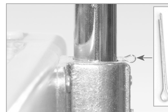
Abb. 5: Splint vor und nach dem Entfernen vom Trapez Tisch.
