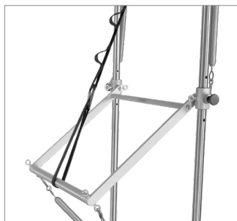
Figure 6 : Sangle de sécurité maintenant la barre Push-through à la position 4 heures d'horloge. La sangle est fixée à la PTB et au cadre de la cage, non pas aux boulons à œil.
