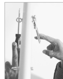
Figura 9: Usare due dita per stringere i bulloni
