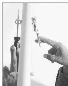
Figure 9 : Utilisez deux doigts pour serrer les boulons
