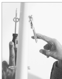
Figura 9: Use dos dedos para apretar las tuercas
