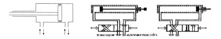
De acción diferencial: permiten mantener el émbolo en cualquier posición, aplicando presión a ambos lados del mismo
