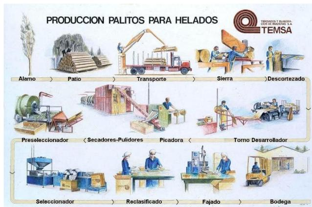
**Figura 2.3** Flujograma de los procesos de producción de palitos de helado en TEMSA. Fuente: [9]
