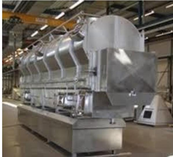
*Figura 2.8 Secadora de Lecho Fluidizado. Fuente: [18]*
