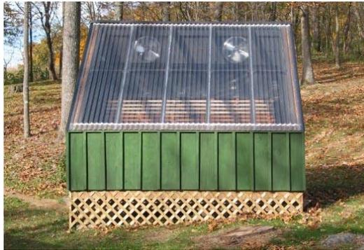
*Figura 2.6 Secador solar de madera. Fuente: [16]*
