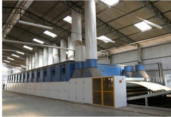
*Figura 2.7 Secador de madera continuo. Fuente: [17]*
