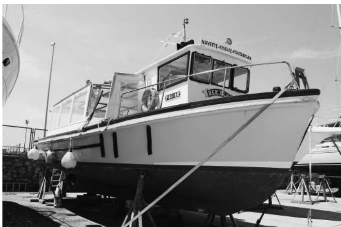
Bote de Hondarribia. Se puede ver la cabina hacia proa y la zona de pasajeros hacia popa, separada ligeramente. Foto: J. M. Matés Luque.
