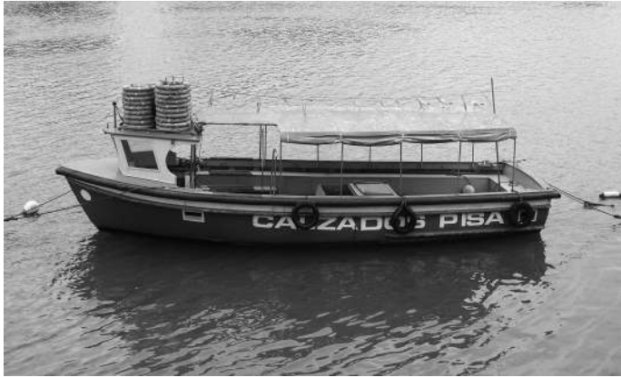
Bote de Portugaleta. Aunque tiene el perfil típico de cabina a proa, la zona de pasajeros están en contacto directo con la proa. Además, la cobertura consiste en un toldo, frente a una estructura más elaborada en los otros botes. Foto: J. M. Matés Luque.
