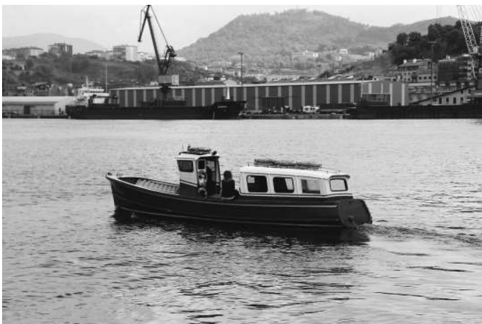
Bote de Pasaia. De pequeñas dimensiones, presenta el perfil típico de cabina a proa y zona de pasajeros hacia popa, con una separación entre ambos. Foto: J. M. Matés Luque.
