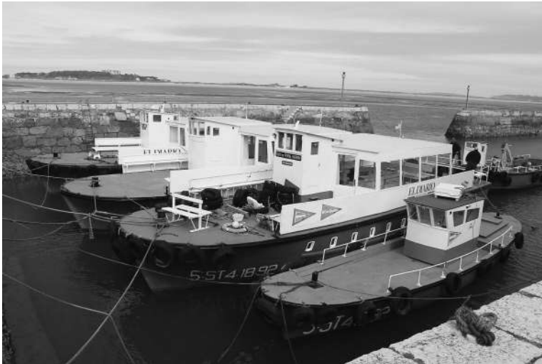
Botes de Santander. Se pueden ver que son distintos en cuanto a la habitación del pasaje pero mantienen la cabina en el centro de la embarcación. Foto: J. M. Matés Luque.
