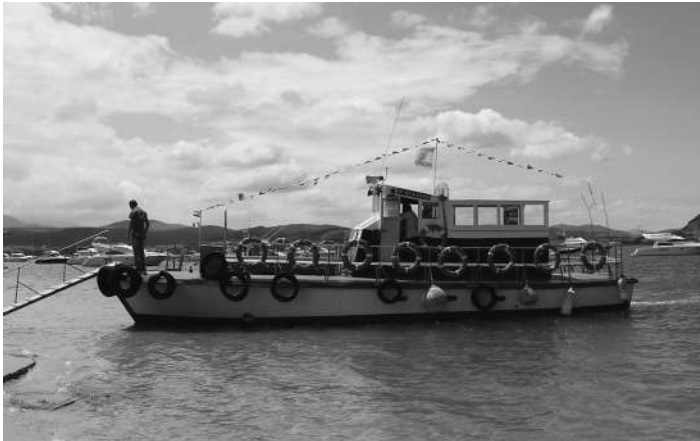
Bote de Santoña. Las condiciones de atracar sobre el arenal hacen que este bote cuente con una pasarela a proa para el embarque y desembarque de pasajeros. Foto: J. M. Matés Luque.
