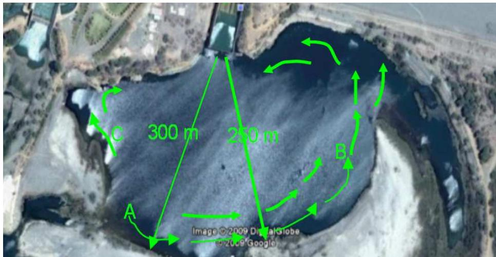
Fig. 7. Fotografía ampliada en donde se muestra el probable comportamiento de las líneas de corriente en la zona del lanzamiento del chorro.
