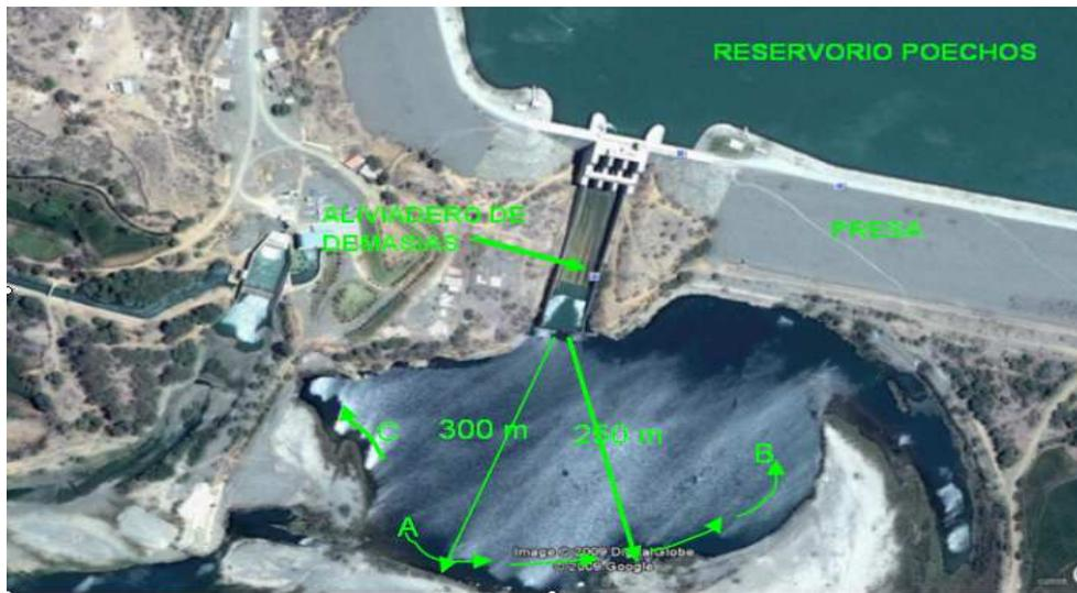
Fig. 6. Fotografía que muestra la erosión generada en planta por el chorro lanzado.
