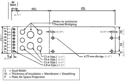
Figure 1 Stud Shear™ Connector Flat Plate
