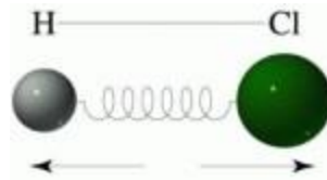
Figura 12. Vibración de una molécula diatómica, HCl.
