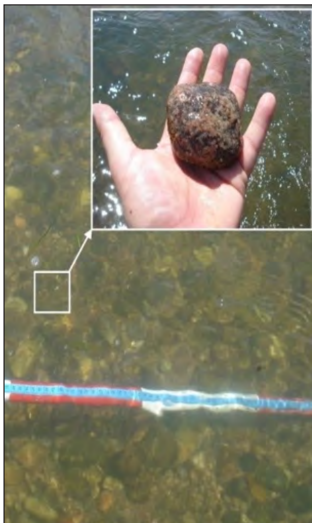
Figura 7. Detalle del acorazamiento del lecho ( 33^{\circ}42'4.37''S 65^{\circ}27'29.45''O ).
