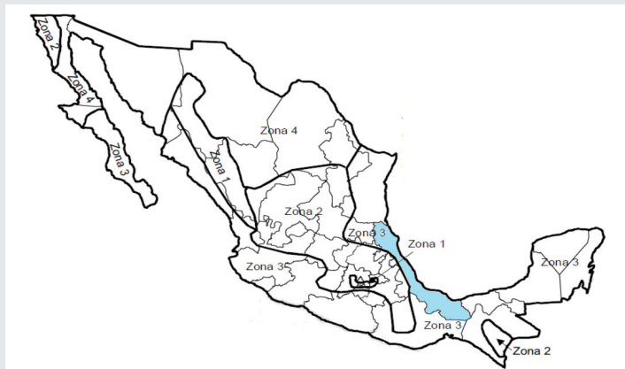
Figura 3. Regiones geográficas para la utilización de asfaltos clasificados según su viscosidad dinámica a 60°C. Fuente: SCT - N-CMT-4-05-001/06.
