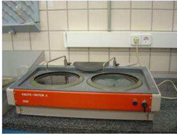
Figura 5-6: Lijado y pulido: 1er paso, lijas n° 500 y n°1000; 2do paso, lijas n° 2400 y n° 4000.
