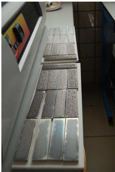
Figura 5-4: Carga del material extraída del horno en la que se observa el efecto del gradiente de temperatura.
