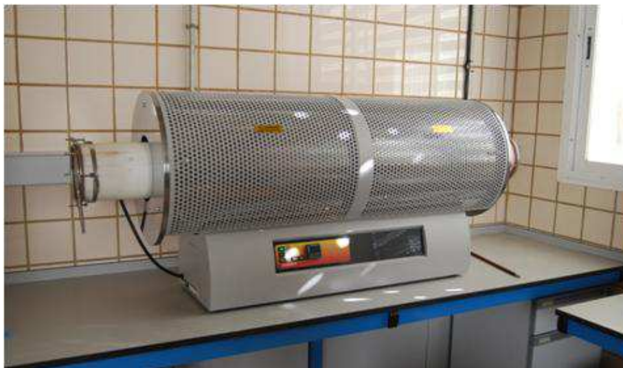
Figura 5-1: Horno de tratamiento térmico adquirido para el proyecto. Marca Carbolite Modelo GHA 12/1050/3216
