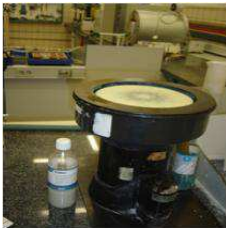
Figura 5-7: Paño húmedo cargado con suspensión de diamante de 3 micras o sílica coloidal de 1 micra
