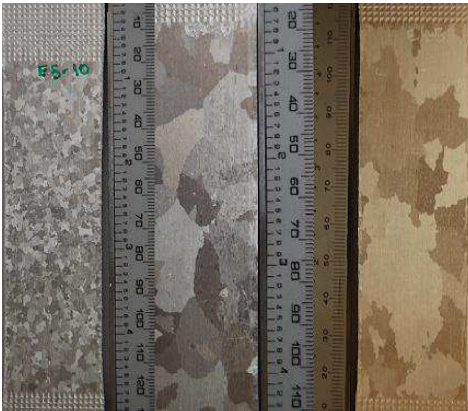
Figura 5-9: Muestra del ataque con el reactivo seleccionado (90% Agua Destilada, 10% Ácido Fluohídrico, Óxido de Molibdeno) correspondientes a probetas deformadas 10, 6, y 5%
