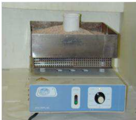
Figura 5-8: Calentamiento de la solución en baño de arena
