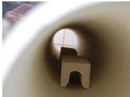
Figura 5-3: Interior del horno en el que se observa el ladrillo que sostiene las placas de alumina. Su geometría permite disminuir la inercia térmica
