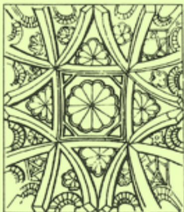
Bóveda de arcos entrecruzados
