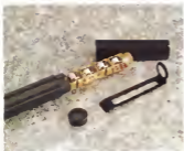
All'interno della penna stessa troviamo ben quattro pile a "batteria".
