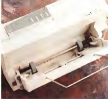
Vascio posteriore con in evidenza i pressori di trasporto della carta
