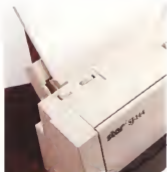
Interruttore di accensione e regolazione del contrasto di stampa
