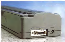
La zona seriale e quella dell'alimentazione
