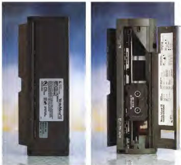
Apertura di speciale portatile e evidenzia il percorso della carta, nonché la fessura di alimentazione.
