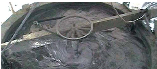
Foto 31: Tanque de cianuración por agitación - Planta La Peter Santander Fotografía: CDMB - Proyecto Río Suratá
