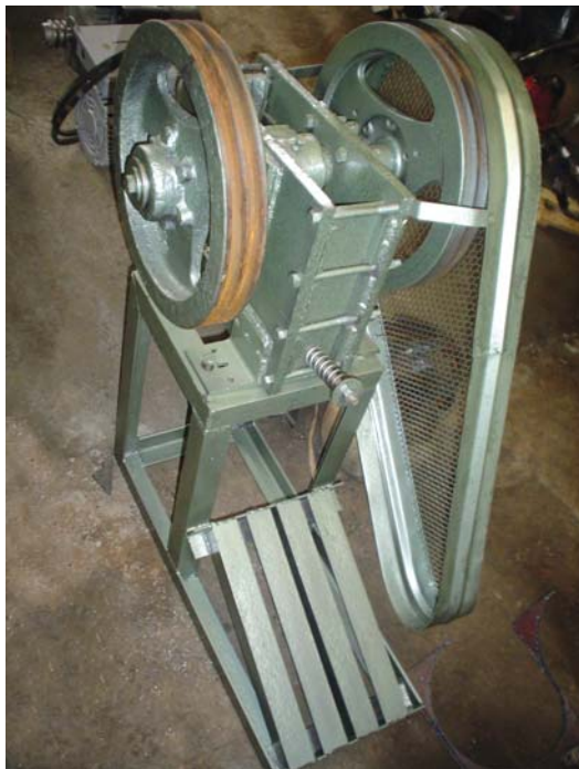
Foto 14: Trituradora de martillo. Foto: taller "Una minga por la pequeña minería aurífera - Corponariño 2005
