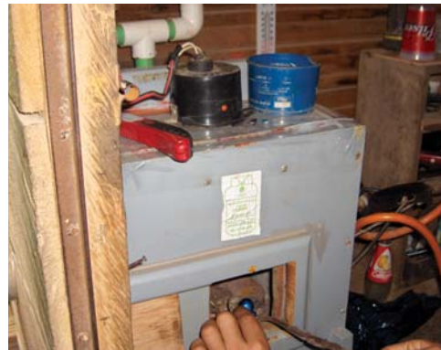
Foto 34: Depurador en Seco. Fundición, la amalgama es recubierta en papel celofán antes de ser fundida.
