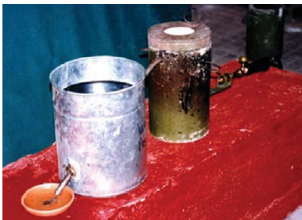
Foto 33: Sistema de retorta y calentamiento cerrado - Foto Proyecto Río Suratá - 2004
