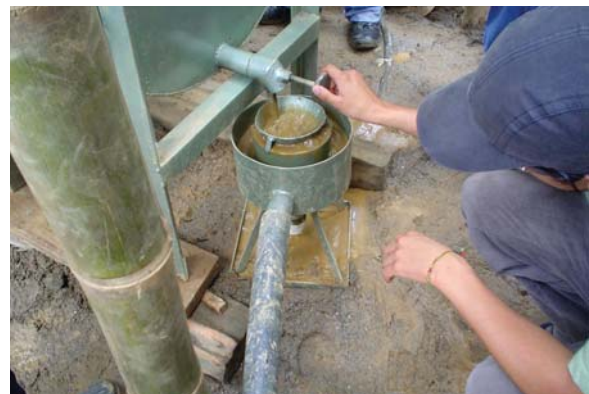
Foto 18: El hidroseparador (o elutriador) CAM Sotomayor (Nariño). Foto, taller "Una minga por la pequeña minería aurífera" Corponariño 2005
