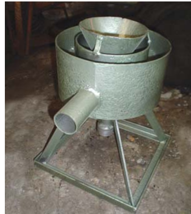
Foto 17: El hidroseparador (o elutriador) CAM Sotomayor (Nariño). Foto, taller "Una minga por la pequeña minería" Corponariño 2005
