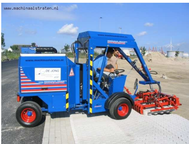
Figura 3. Ejemplos de máquinas para colocación mecánica de elementos para pavimentación.
