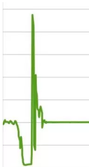
Figura 2 - Diagramma dell'accelerazione lungo l'asse z durante l'esperienza di caduta del grave attraverso lo smartphone
