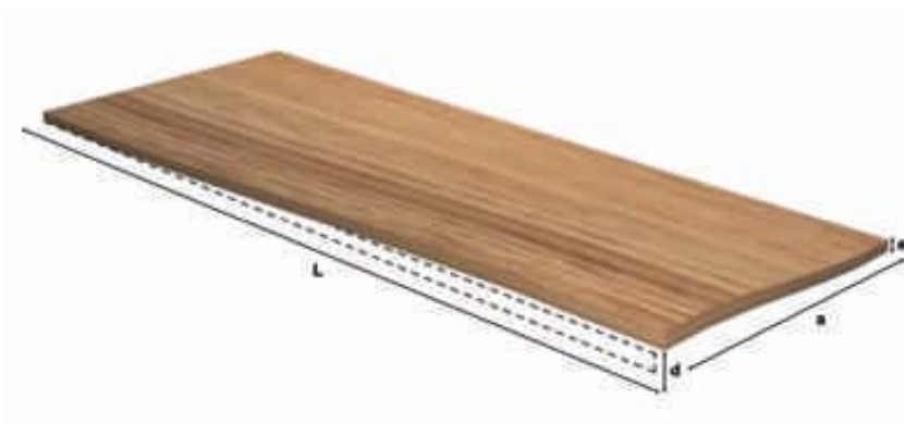
Figura 142. Torcedura o revirado de la madera.
