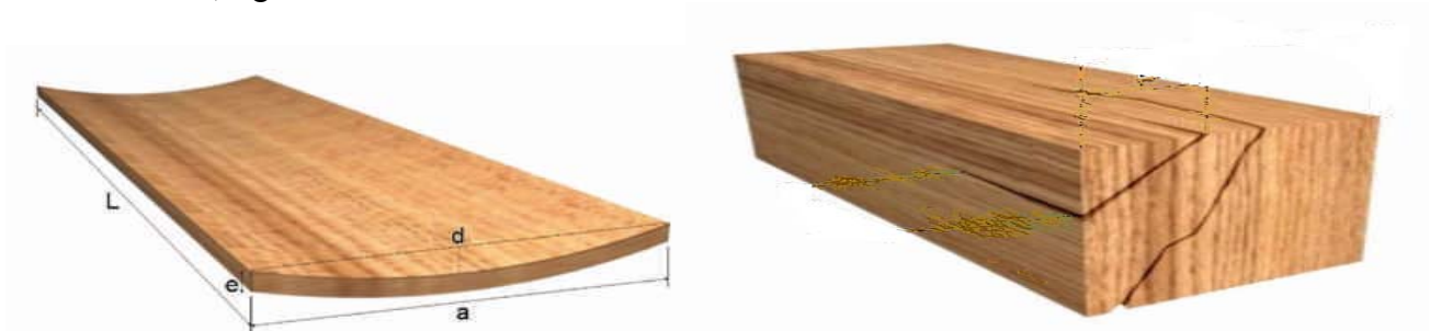
Figura140. Acanaladura y grietas en la madera.
