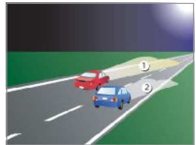
El adelantado (2) sigue con la luz alta y la sustituye por la baja cuando pueda deslumbrar al que adelanta (1), que sigue con la luz alta.
