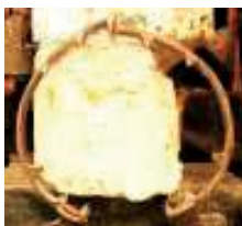
Trepadores, utilizados por los electricistas para subir a los postes de la luz. CP. PA
