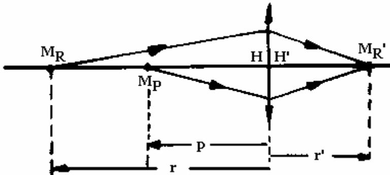
Máxima amplitud de acomodación:  $Am = R - P = (1/PR) - (1/PP)$
