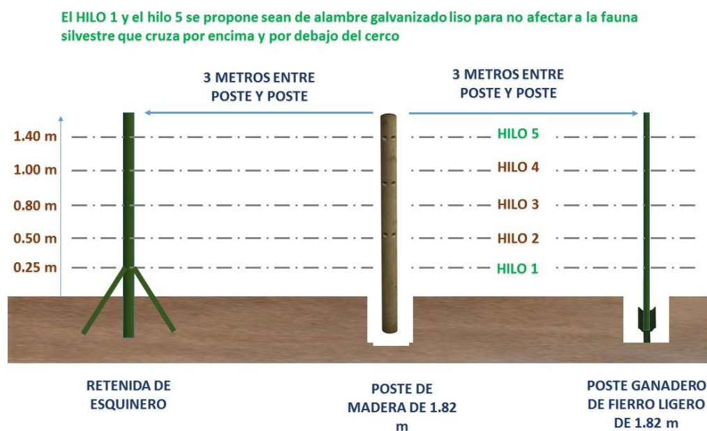
Figura 6 Vista esquemática de las características óptimas del cercado a implementar en caso de ser necesario.
