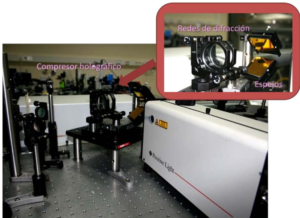
Esquema del montaje empleado para caracterizar el compresor con el láser Ti: zafiro de longitud de onda \lambda = 800 \text{ nm} . Se muestra una fotografía ampliada del compresor
