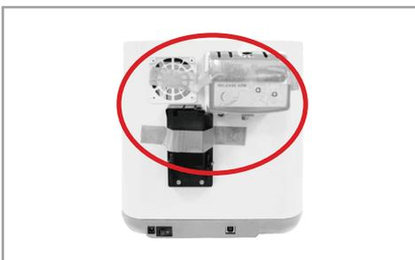
07 Retire la cinta fijada del soporte de la bobina de filamento y del módulo de alimentación.
