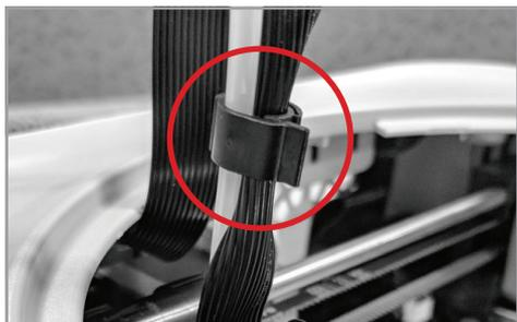
**04** Utilice la abrazadera para sujetar el tubo guía del filamento y el cable plano. (Coloque la abrazadera en la marca del cable plano).
