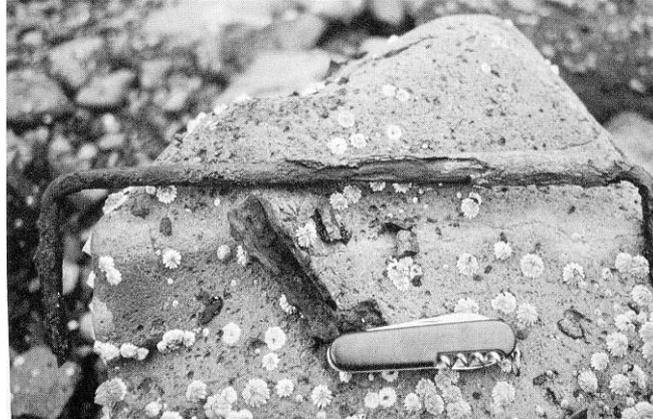
Tipos de ambientes corrosivos: agua de mar; aire marino salino; ácidos; terrenos, en especial los que contienen cloruros o sulfatos; pasta de yeso; cementos con oxiclورو de magnesio; cenizas y escorias; muchos compuestos sulfurados.
