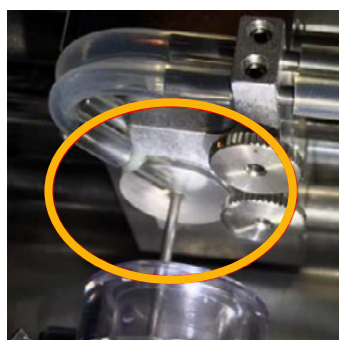
Limpieza del cabezal de lavado. Cabezal de lavado sin sal ni sangre presente en la superficie
