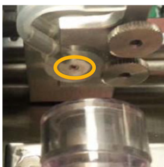
Cabezal de lavado con mínima acumulación de sal en la superficie
