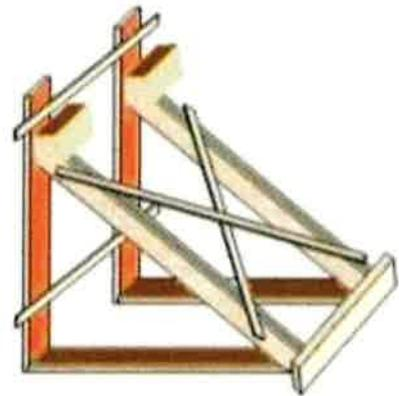
**Apeo de muro con tornapuntas:** Para contener un desplome o un cedimiento en un muro de fachada, el sistema más común que se emplea es el de tornapuntas, constituidos básicamente por puntales que se acodan entre el suelo y el muro mediante un durmiente y una muletilla o ejión.
