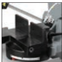
Χυτοσιδηρή μόρσα με σύστημα ταχείας ολίσθησης
