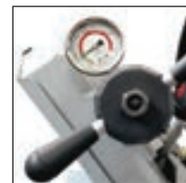
Μεγάλη λαβή τεντώματος κορδέλας και ένδειξη σε μανόμετρο
