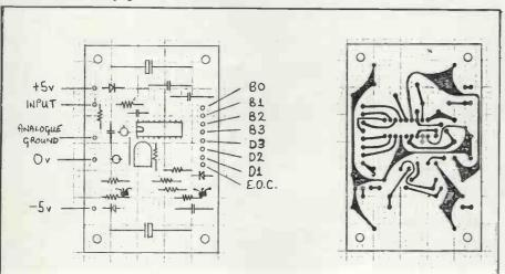
FIG 9. PRINTED CIRCUIT BOARD LAYOUT (BASIC CIRCUIT).
