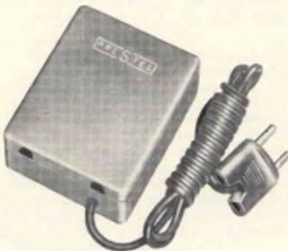
Fig. 7 - Alimentatore Prestel A6N per l'amplificatore di cui alla figura 6. Entrata 200 Vc.a. uscita 12 Vc.c. stabilizzati. Da aggiungere dietro al televisore.
