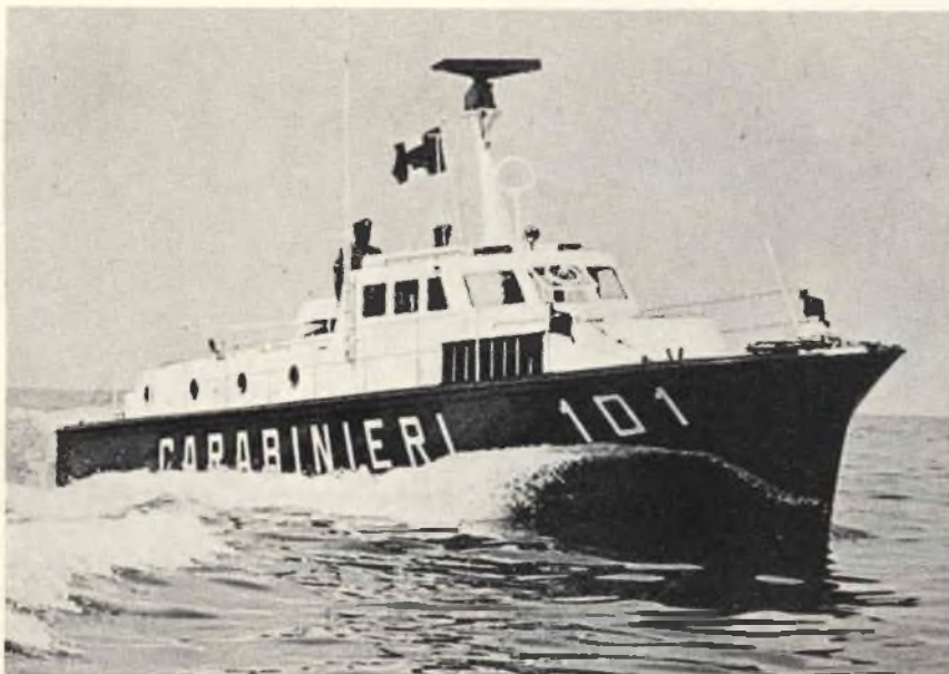
Fig. 1 - MEZZO DI SALVATAGGIO DEL SERVIZIO MOBILE MARITTIMO - Motovedetta di altura dei Carabinieri con 35 ore di autonomia, provvista di radio-apparati rice-trasmittenti, radiogoniometro e radar.
