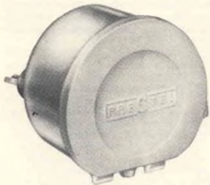
Fig. 6 - Amplificatore monocanale della Prestel (GBC) Italiana TR2 VHF per l'amplificazione dei segnali televisivi nei canali I, II e III. Guadagno 32 dB (40 volte) da installare esternamente vicino al dipolo ed alimentato dalla stessa linea di discesa.
