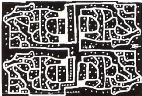
Fig. 4 - Circuito stampato in grandezza naturale della prima versione realizzativa. Fig. 5 - Circuito stampato in grandezza naturale della seconda versione realizzativa.
