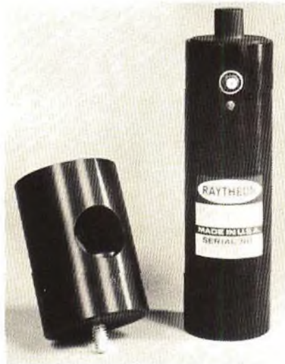
Fig. 4 - Rivelatore fotovoltaico di raggi infrarossi funzionante nella gamma compresa fra 8 e 12 micron. Tempo di risposta 15 ns.
