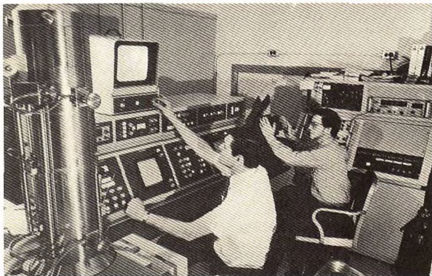
Fig. 7 - Foto illustrante la complessa apparecchiatura attraverso la quale si ottiene l'abbinamento tra il «computer» ed il microscopio.
