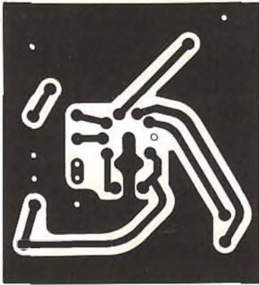
Fig. 9 - Circuito stampato dell'amplificatore a grandezza naturale.
