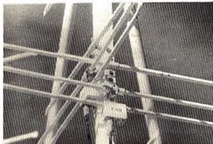
Particolare delle antenne-tracking: dipoli incrociati; da notare la raffinatissima meccanica.
