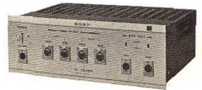
Fig. 2 - Aspetto del codificatore Sony SO per la registrazione di un disco stereo-quadrifonico.
