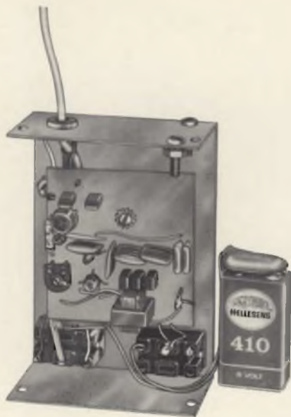
Fig. 5 - Vista interna dell'iniettore di segnali a montaggio ultimato.
