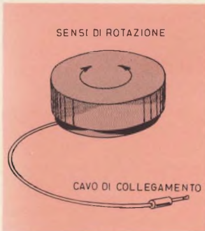
Fig. 7 - Esempio di struttura del comando a pedale del tipo a pedana rotante.
