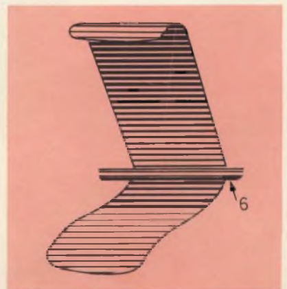
Fig. 11 - Aspetto della molla in nastro di acciaio, mediante la quale si provoca il ritorno del pedale alla posizione originale, quando viene meno la pressione del piede.
