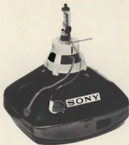
A sinistra: convenzionale tubo tricromico completo di circuiti per la convergenza dinamica. A destra: un cinescopio per TVC Trinitron della Sony.
