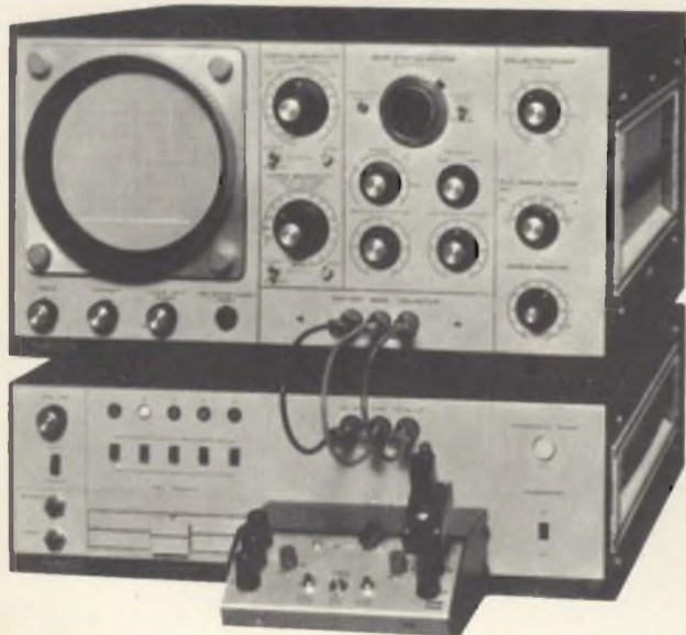
Fig. 8 - Strumenti professionali per Laboratori ad alto livello. Il tracciatore di curve programmabile per semiconduttori Systron-Donner mod. 6200 B/P (Ing. Vianello).
