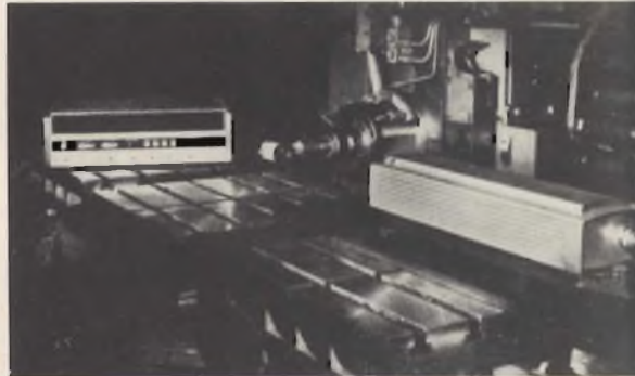
Fig. 7 - Altra foto illustrante l'impiego dello interferometro a laser su di una macchina utensile, per controllare la messa a punto.
