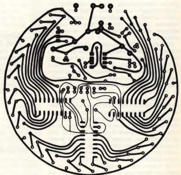
Fig. 5-A - Basetta stampata vista dal lato rame del contagiri elettronico.
