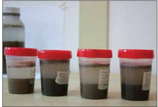
Preparación de las muestras para la aplicación de papeles reactivos para medición del pH y alcalinidad / Foto: Archivo Técnico Proyecto de Conservación de los Edificios Dañados por los Sismos de 2017 en Monte Albán-Atzompa.
