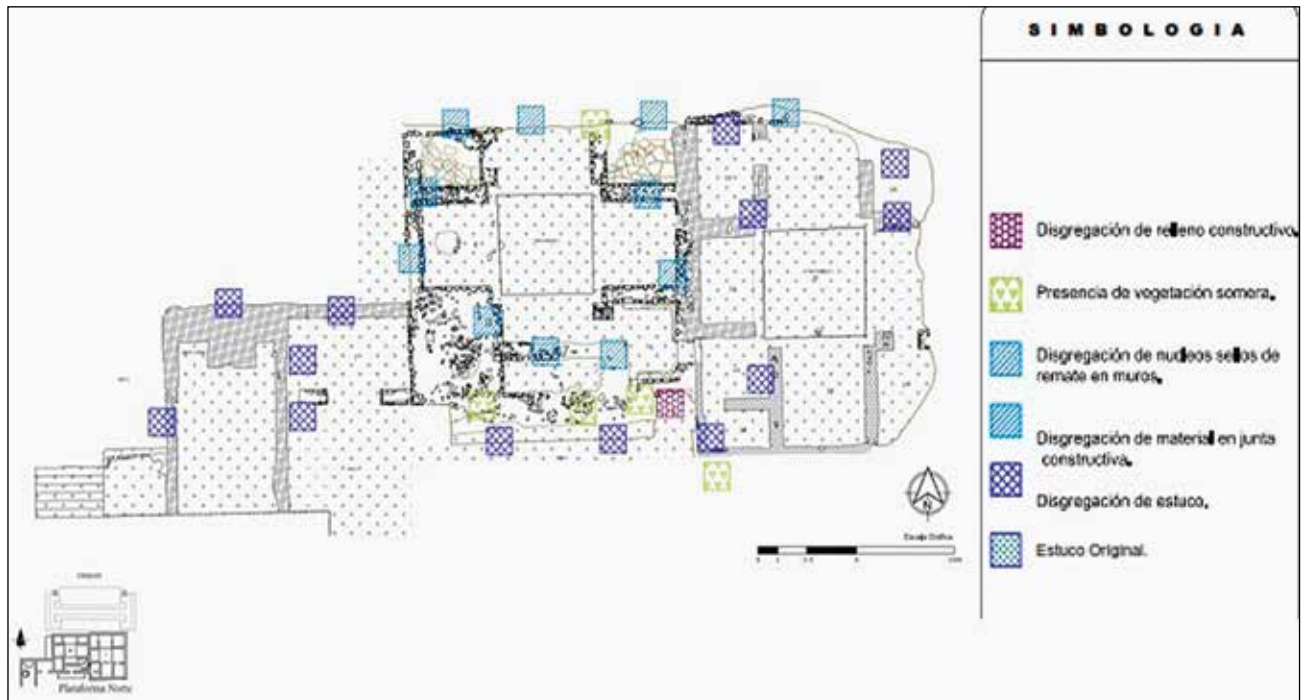
Cédula de registro de deterioros elaborada para programar las actividades de consolidación y restauración / Archivo Técnico Proyecto Conservación de los Edificios Dañados por los Sismos de 2017 en Monte Albán-Atzompa.
