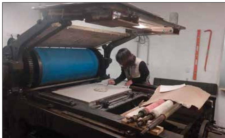
Trazado del dibujo en la matriz de piedra montada en la prensa / Foto: Isis G. Martorell.
