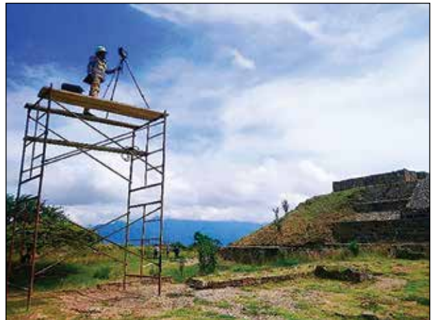
Componente 1. Conjunto vértice geodesico. Scanner montado sobre andamios / Foto: Archivo Técnico Proyecto de Conservación de los Edificios Dañados por los Sismos de 2017 en Monte Albán-Atzompa.
