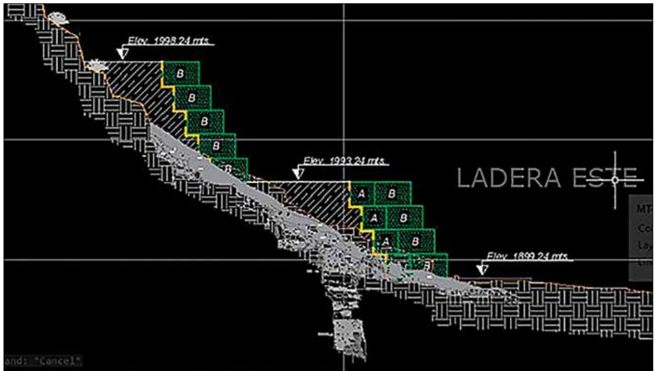
Detalle de la propuesta de gaviones estructurados en el trazo de la Cala 6. Se muestra la estratigrafía y pozo de sondeo realizados en la exploración arqueológica / Foto: Archivo Técnico Proyecto de Conservación de los Edificios Dañados por los Sismos de 2017 en Monte Albán-Atzompa.
