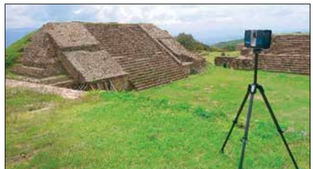
Componente 1. Posicionamiento sobre el terreno aprovechando los volúmenes y elevaciones de los edificios / Foto: Archivo Técnico Proyecto de Conservación de los Edificios Dañados por los Sismos de 2017 en Monte Albán-Atzompa.
