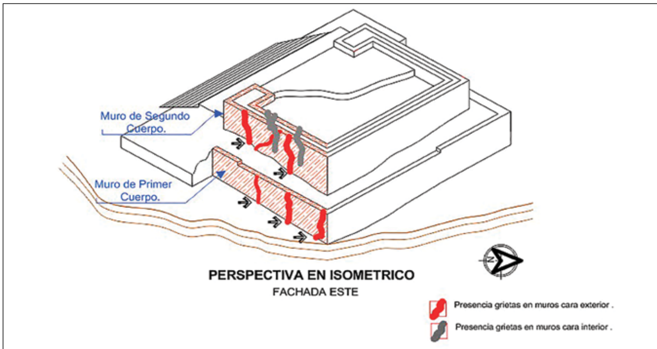
Fachada este del Edificio 16. Daños ocasionados por el sismo en el primer y segundo cuerpo / Foto: Archivo Técnico Proyecto de Conservación de los Edificios Dañados por los Sismos de 2017 en Monte Albán-Atzompa.
