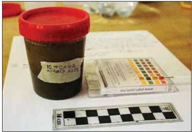
Corroborando valores de pH registrados en la muestra del suelo del estrato 1C / Foto: Archivo Técnico Proyecto de Conservación de los Edificios Dañados por los Sismos de 2017 en Monte Albán-Atzompa.
