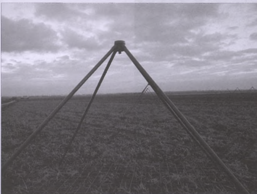
Rys. 14. Model anteny LOFAR – LBA
