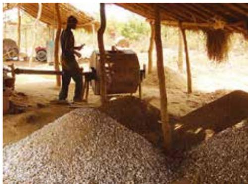
*Las rocas se trituran manualmente usando martillos (no se muestran) y después se muelen utilizando molinos de bolas (Tanzania, 2010).*
