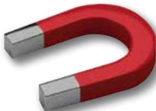
Se utiliza un imán de mano para remover los minerales no deseados, teniendo cuidado de no perder el oro. Para esto se usa un imán debajo (o encima) de la batea para separar los minerales magnéticos de los no magnéticos; lo cual también incrementa la intensidad del magnetismo en algunos minerales. Un pedazo de papel o de plástico se puede utilizar para cubrir el imán para que los minerales se remuevan fácilmente.
