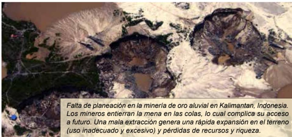
*Falta de planeación en la minería de oro aluvial en Kalimantan, Indonesia. Los mineros entierran la mena en las colas, lo cual complica su acceso a futuro. Una mala extracción genera una rápida expansión en el terreno (uso inadecuado y excesivo) y pérdidas de recursos y riqueza.*
