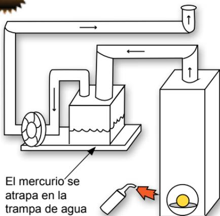
**ejemplo** El condensador de mercurio tipo “waterbox” (caja de agua) es una adición económica y fácil de construir para un pequeño extractor que se utiliza en muchas tiendas de oro. El vapor de mercurio se mueve por medio de un ventilador. El vapor se convierte en burbujas dentro de un recipiente plástico en donde se enfría. Esto resulta en la condensación del mercurio y su depositación debajo del agua, aislado de la atmósfera. Este se puede recoger y reutilizar.
