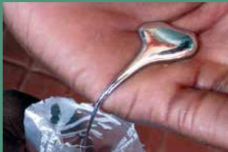
4 El mercurio se mezcla con el concentrado, muchas veces a mano, atrayendo partículas de oro y formando un líquido pesado que se deposita en la parte inferior de la cubeta.
