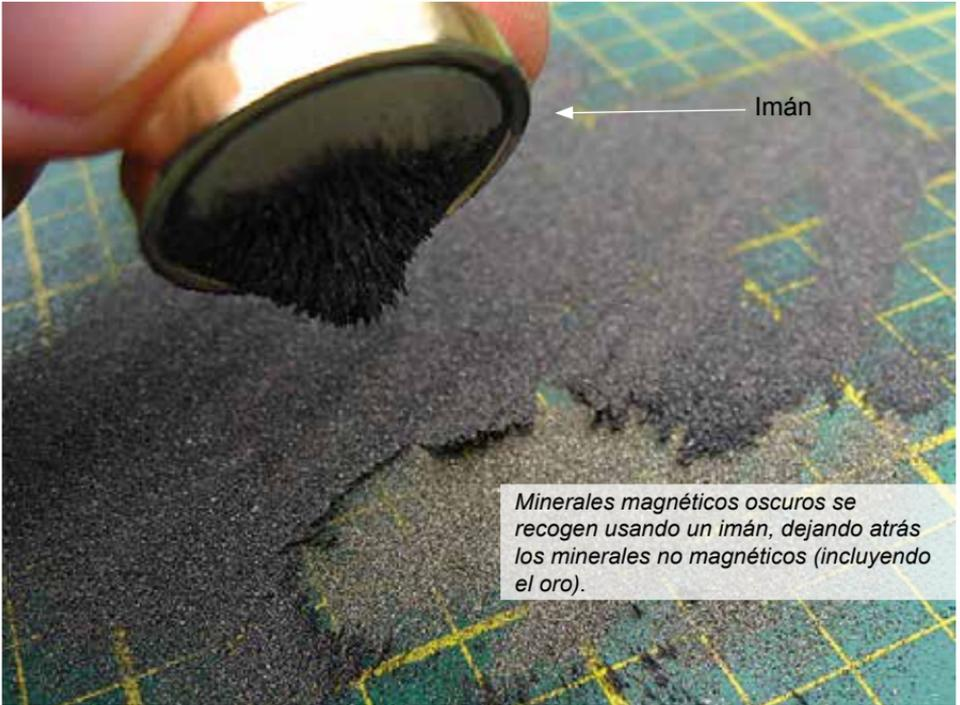
También se utilizan imanes en el fondo de canaletas formando una “carpetita de magnetita”. En ciertos casos, las canaletas magnéticas pueden mejorar la eficiencia en la recuperación de oro fino en los concentrados. Se instala una capa magnética delgada en una canaleta pequeña en donde las partículas del mineral magnético se recogen en la superficie, las cuales forman una capa en la que se depositan partículas de oro fino. La canaleta contiene bandas magnéticas polarizadas en su extensión.
