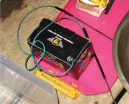
*Izquierda – Batería de 9V usada en la activación del mercurio. También sirven seis baterías comunes de 1.5V conectadas en serie.*
