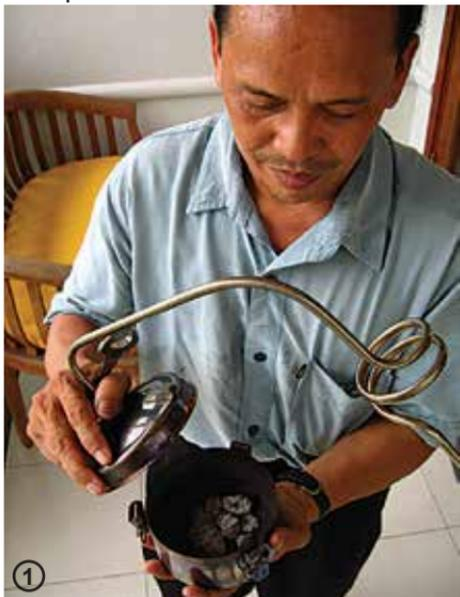
Las retortas calientan la amalgama en una de sus partes y enfrían y condensan el vapor de mercurio en otra, permitiendo la re-utilización del mercurio.
