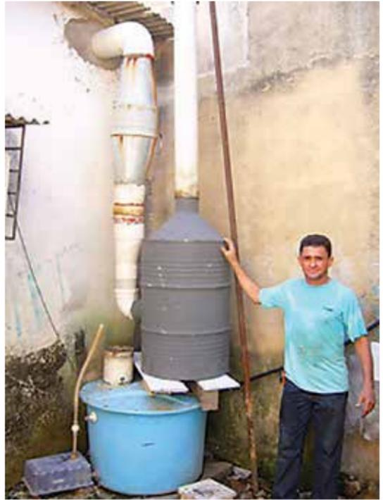
**ejemplo** Este extractor, diseñado por la USEPA (Agencia de Protección Ambiental de los Estados Unidos), utiliza canecas de gasolina, placas de impacto, y un ventilador para atrapar los vapores de mercurio. En general la caneca se encuentra adjunta al tubo de escape del extractor y el mercurio se recoge en la caneca.
