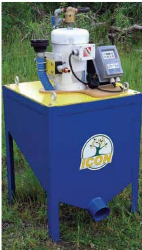
*Izquierda - La máquina Icon™, desarrollada por Falcon Concentrators, está diseñada para procesar hasta 2 toneladas de mineral por hora. Los modelos de este tipo tienen un costo de entre 5000-10,000 US\$. Abajo - Centrífuga construida en Zimbabwe que utiliza barras de turbulencia para mover el concentrado. Esta centrífuga no es eficiente pero es relativamente barata, con un valor alrededor de 1,000-2,000 US\$.*
