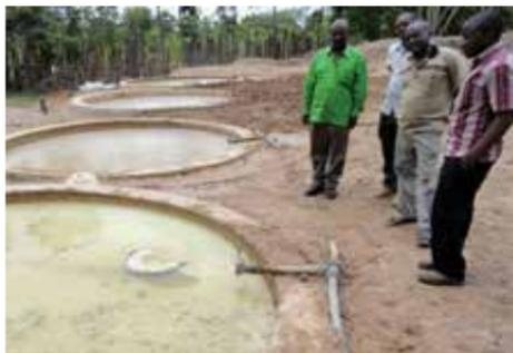
*Izquierda – Planta de procesamiento de cianuro a pequeña escala. Tanques de cemento utilizados para la lixiviación en cubas; Abajo, izquierda – Solución de cianuro proveniente de las cubas; Abajo, centro – Carbón activado utilizado para absorber oro – complejos de cianuro en solución; Abajo, derecha – Laboratorio químico y equipo de seguridad esencial presente en el proyecto y mineros capacitados para su uso (Tanzania).*
