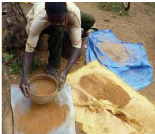
*Fotos arriba e izquierda - Mineros trituran las rocas manualmente con un mortero de acero (no se muestra). Posteriormente tamizan el material triturado para producir pilas de mena fina que pasan a la etapa de concentración (Mali, 2011).*
