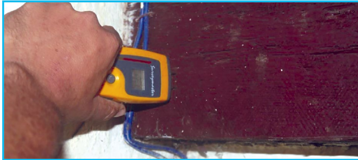
Fig. 16: Medición de la humedad superficial de la madera con el higrómetro
