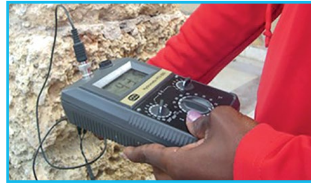
Fig. 82: Realización de ensayos de humedad superficial
