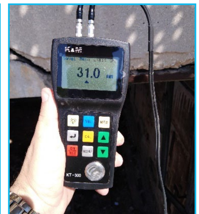
Fig. 144: Medición in situ en acero de refuerzo. Teatro Campoamor
