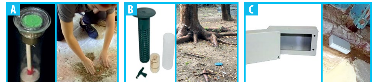
Fig. 161: Tipos de sistema de cebos. A: Estación Green Eye para detección temprana. B: Estación de suelo para tierra y hormigón. C: Estación de pared para localizar las termitas en el interior de la edificación
