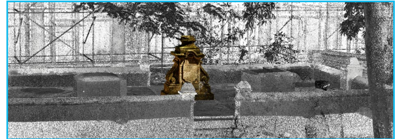
Fig. 203: Nube de puntos del TLS (escala de grises), y nube de puntos obtenidas por la fotogrametría (color) unidas en solo sistema de coordenadas
