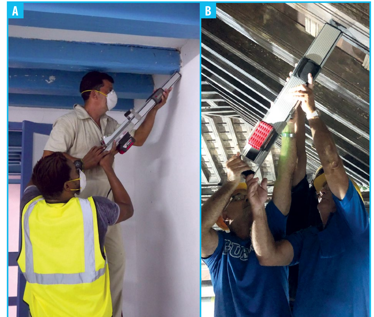
Fig. 146: Resistografía en las vigas. A: Museo Simón Bolívar. B: Convento Santa Clara de Asís
