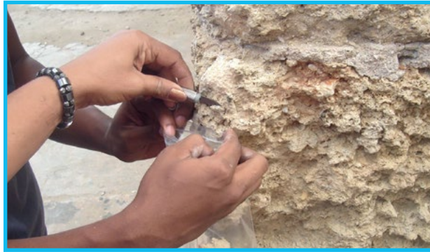
Fig. 81: Toma de muestras para ensayos en laboratorio
