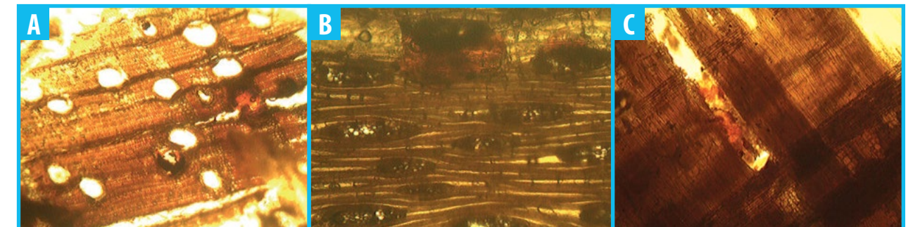
Fig. 149: Cortes histológicos del cedro vistos al microscopio óptico 40x. A: Transversal. B: Longitudinal tangencial. C: Longitudinal radial. Palacio del Segundo Cabo
