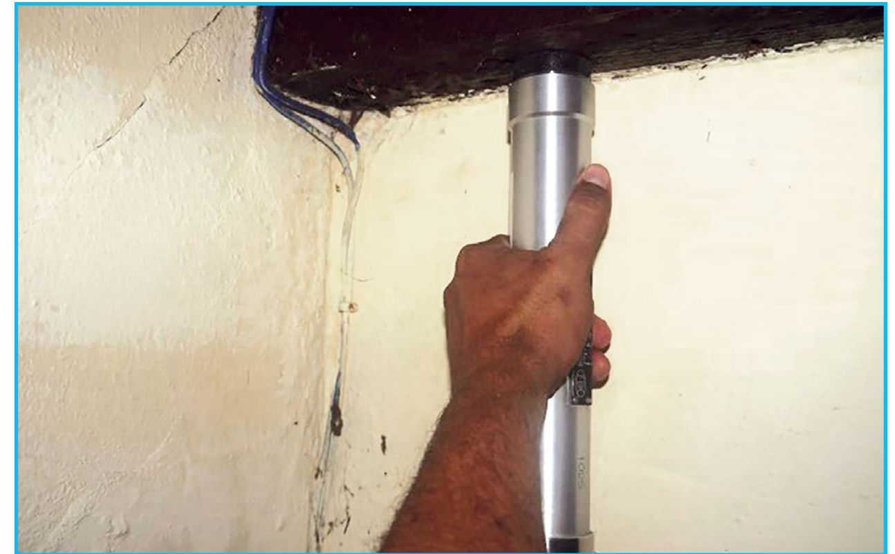
Fig. 19: Ensayo de penetración en la madera con el Pilodyn 6J. Restaurante La Mina
