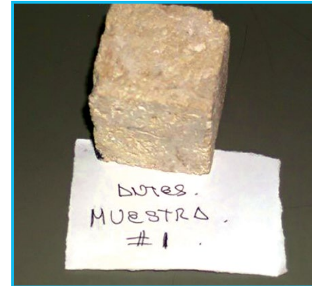
Fig. 83: Antes de la realización del ensayo de cristalización de sales. Foto tomada en laboratorio
