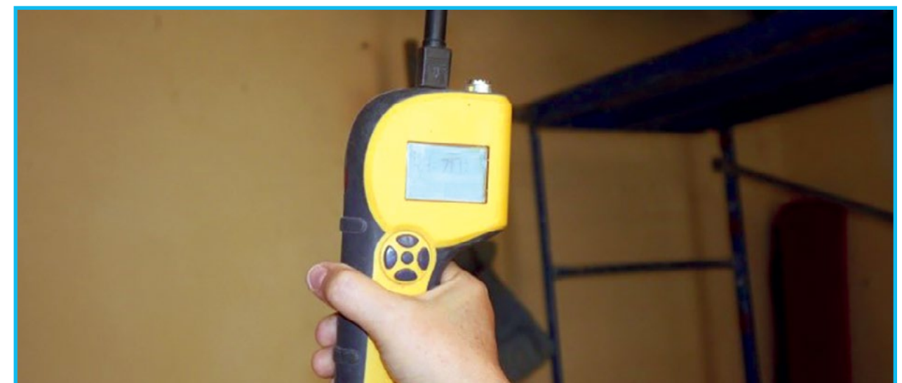
Fig. 15: Medición de los parámetros ambientales con el termo-higrómetro
