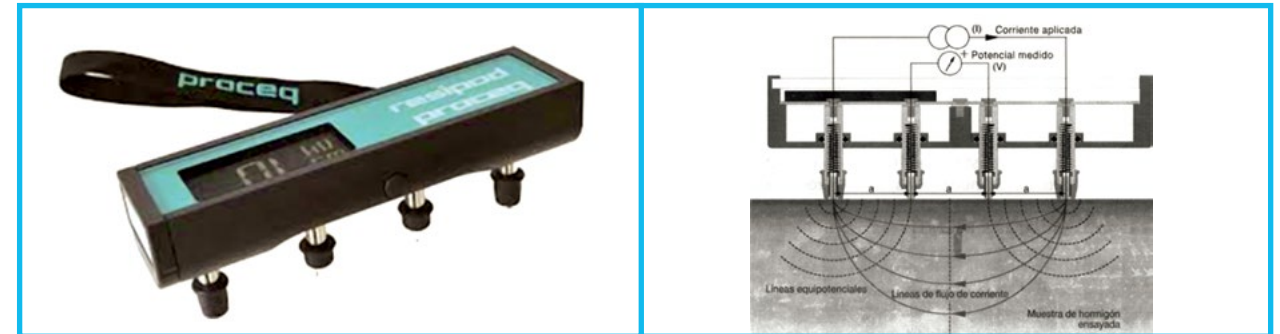
Fig. 130: Equipo de medición y esquema de funcionamiento de la técnica de resistividad eléctrica del hormigón. Equipo Proceq Resipod
