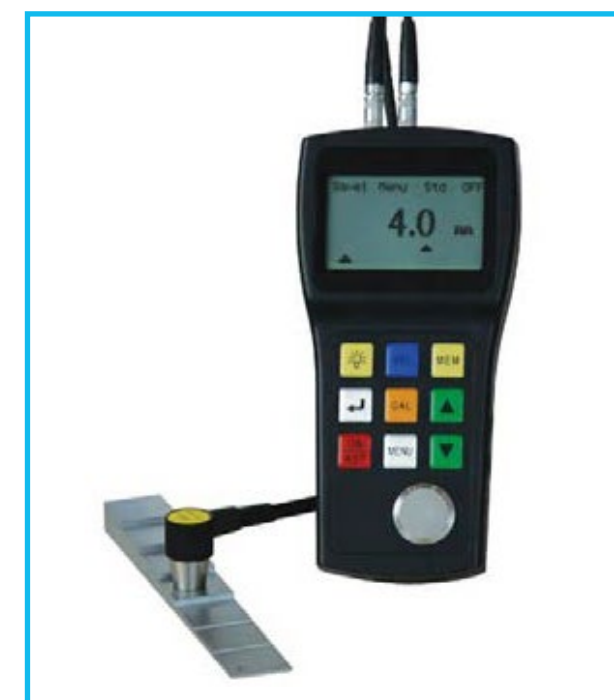
Fig. 143: Equipo medidor de espesor metálico
