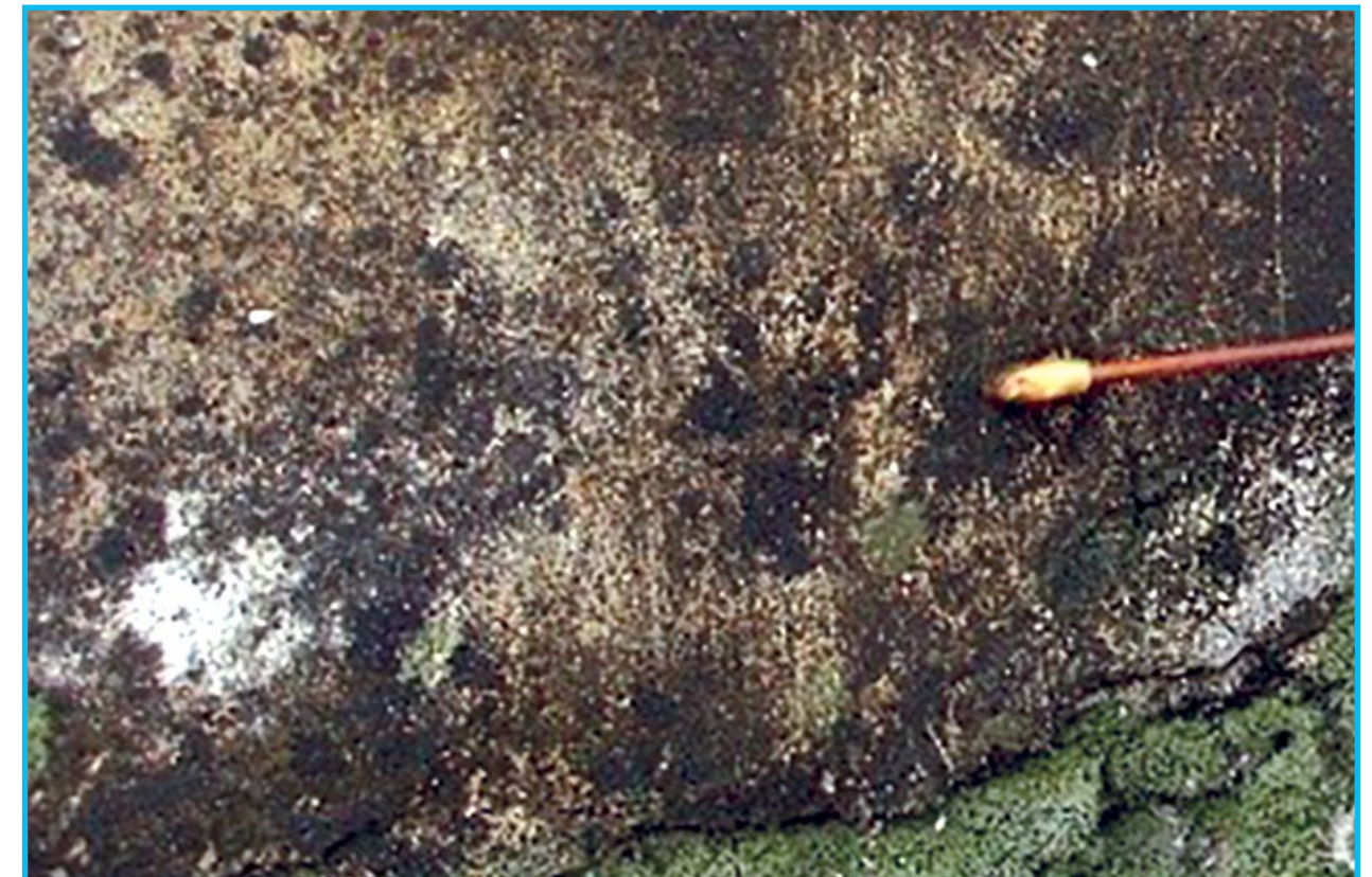
Fig. 170: Detalle de zonas muestreadas mediante hisopado. Convento de San Francisco de Asís
