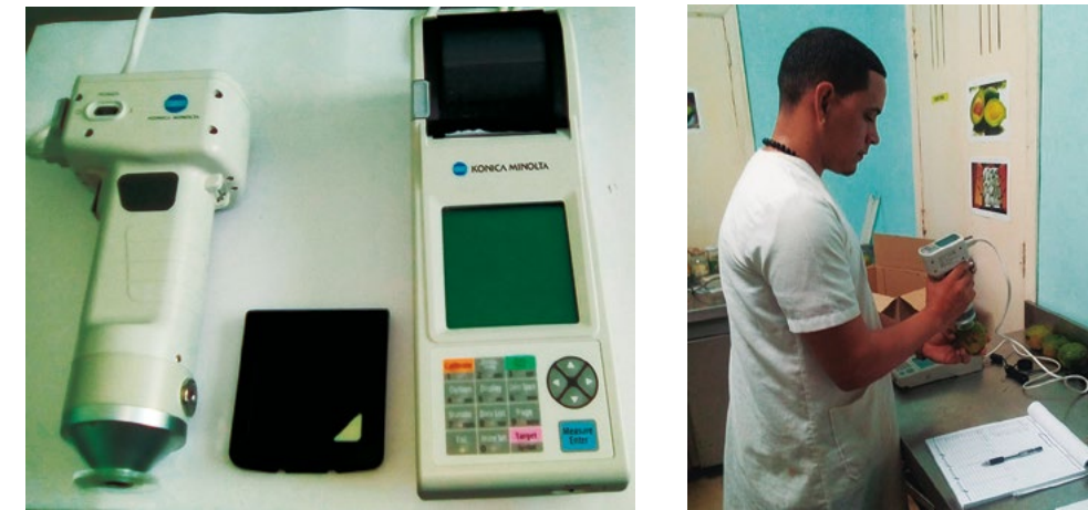
Fig.1. Colorímetro para la medición del color del exocarpio y mesocarpio en las frutas. Fotos tomadas por los autores..
