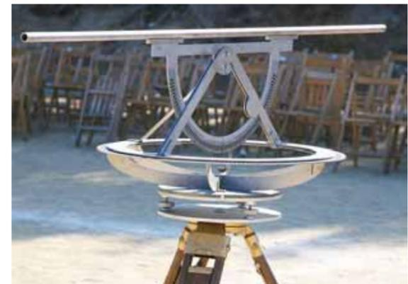
HERÓN DE ALEJANDRÍA: La Dioptra: ...dispone de un remate del apoyo en forma de un capitel dórico...un disco horizontal graduado (limbo horizontal)...un semicírculo vertical (limbo vertical)...
