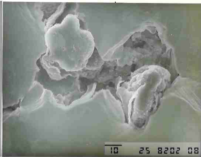
FIGURA 50 - Coalescimento de alvéolos formados sobre nódulos de grafita. Liga nº11, 27% perlita, sem hidrogênio. Intensa deformação plástica.
