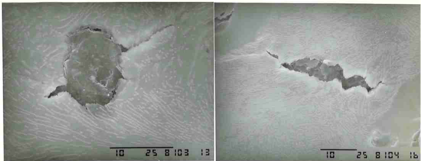
FIGURA 63 - Início de formação de trincas junto a nódulos de grafita envoltos por perlita. Liga nº 11, 45% perlita, com hidrogênio.
