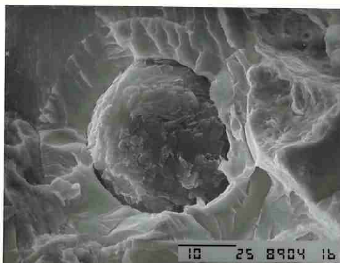
FIGURA 92 - Fratura de amostra com hidrogênio. Liga nº 14, 84% perlita, bruto-de-fundição. A fratura por clivagem revela a estrutura de "olho-de-boi".
