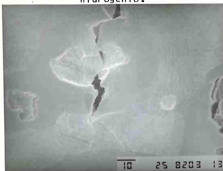
FIGURA 59 - Bloqueio de trinca por área de perlita. 45% perlita, sem hidrogênio.
