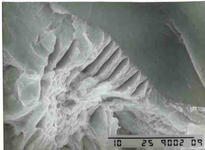
FIGURA 87 - Superfície de fratura de corpos-de-prova de tração. Liga nº 12, bruto-de-fundição, 45% perlita, sem hidrogênio. Clivagem e fratura alveolar da perlita. Trincas secundárias.
