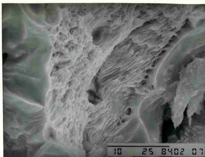
FIGURA 81 - Fratura alveolar da perlita. Liga nº 11, 68% perlita, sem hidrogênio.
