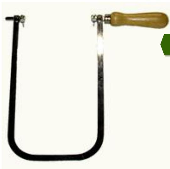
Segueta: la misma es utilizada para cortes irregulares y de piezas muy específicas. La madera que se utiliza generalmente es aglomerado o fibrofácil.
