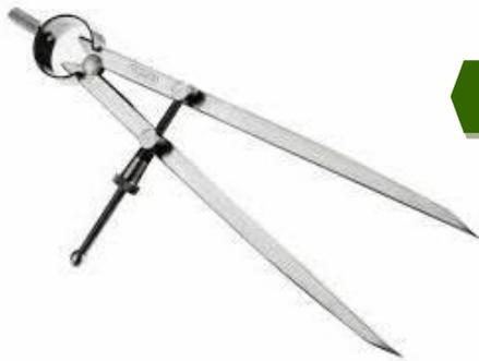
➤ Compás: el compás se utiliza para marcar pequeño círculos y arcos. Para hacerlo, colocar una punta sobre el primer borde y marcar el centro con la otra punta y luego repetir con el borde adyacente. El centro del círculo (donde debe colocar el compás para marcar el círculo) es donde está la intersección de las dos marcas.
