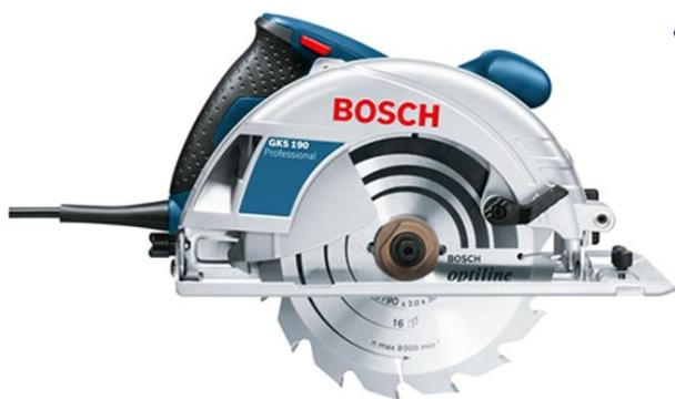
Sierra circular portátil: se la utiliza para realizar cortes rectos. Se pueden obtener distintas hojas para cortar en el sentido de la veta o en forma transversal. Vienen en varios diámetros y se pueden ajustar para realizar cortes más o menos profundos elevando o bajando la placa de la base, y de este modo realizar cortes parciales o totales. La placa de base se puede ajustar también a 45°.
