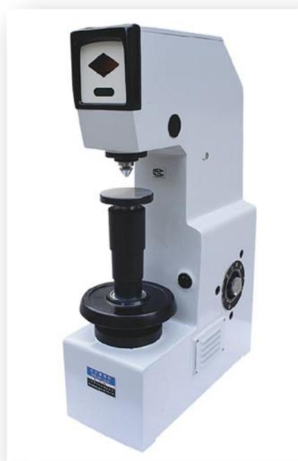
+ El Brinell es un instrumento que comprueba la resistencia de los materiales.
