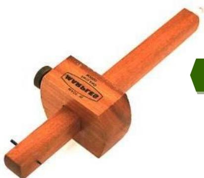
Gramil: es un instrumento para trazar una pieza de madera. Para hacerlo se toma una medida con una regla metálica o un metro plegable y se traslada la misma desde el macizo hasta la punta de trazar, se asegura el brazo móvil y se procede a trazar sobre la pieza deseada a la medida antes estipulada.
