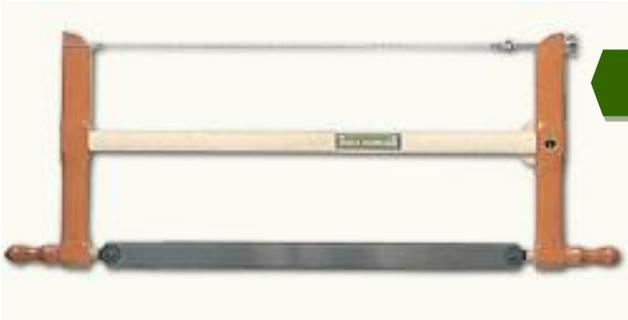
➤ Serrucho de arco: es utilizado para cortes irregulares y curvos, de secciones específicas.
