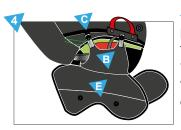
4. Using a small cord, push the line « C » through the left grommet of the flexible flap « B », and then through the grommet of the lower left flap « E ».
